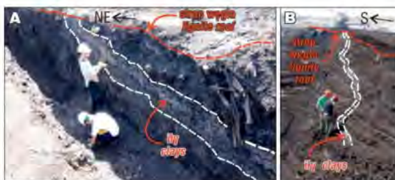
Ryc. 10. Poddarcie warstwy iłów w brzeżnej strefie ich występowania: A – o ok. 1 m na dystansie poniżej 10 m, B – o blisko 3 m na dystansie ok. 50 m
